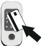
3. Поместите RF карту рядом с областью для считывания карт. Четыре звуковых сигнала служат подтверждением успешного удаления.
