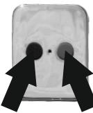
2. Нажмите и удерживайте левую и правую клавиши на внутренней панели нажатыми в течение пяти секунд. Двойной звуковой сигнал указывает на то, что вы активировали режим сброса настроек. Кнопки [\*] [#] высветятся на внешней панели.
