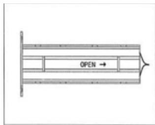
3. После снятия батарейного отсека сдвиньте крышку батарейного отсека в направлении, указанном стрелкой, снимите крышку батарейного отсека, извлеките элементы питания. Установите новые, соблюдая полярность. Закройте крышку батарейного отсека и установите его, закрутите два винта.
