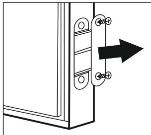
2. Используя отвертку, выкрутите два фиксирующих винта и осторожно выньте батарейный отсек. Будьте осторожны, не повредите кабель батарейного отсека.
