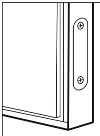
1. Найдите батарейный отсек (отсек обычно фиксируется в торце дверного полотна). В зависимости от типа двери, расположение может быть другим, обратитесь к дистрибутору.
